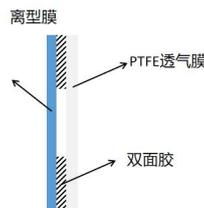
\*IP68:1米水深48h    \*\*产品粘贴后，需放置24h在进行使用或测试。
